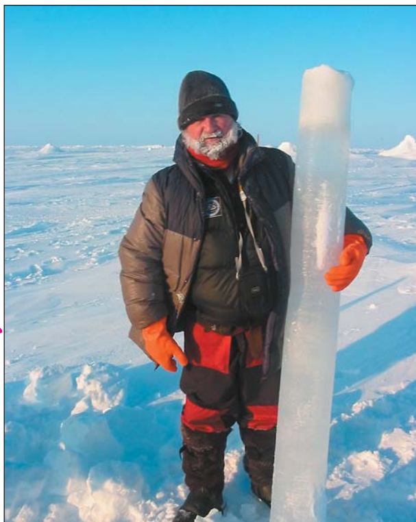
И.А.Мельников с ледовым керном, выбуриваемым из льда специальным кольцевым буром.
